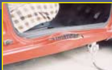
Smerigliare e saldare i Bit sulla linea da ripristinare
